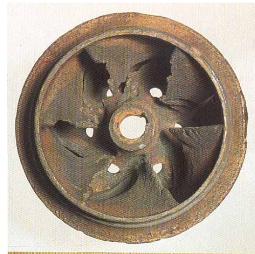
Eksempel på erosions korrosion i et løbehjul af støbejern
