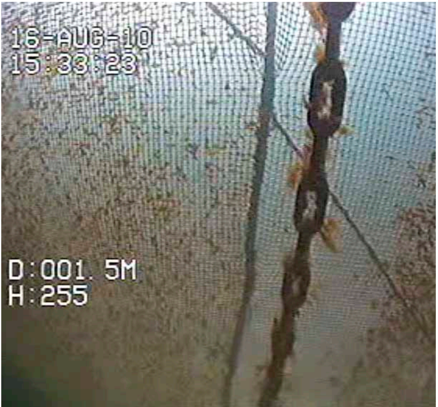
Figur 1 Not med område hvor begroing er slitt vekk (Foto fra Fiskeridirektoratet).
